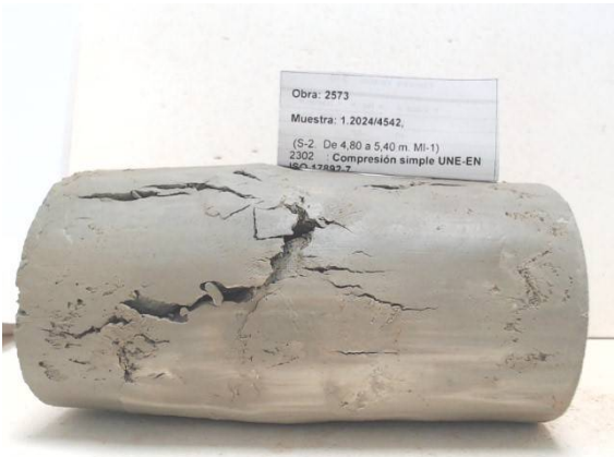
Probeta tras compresión simple
